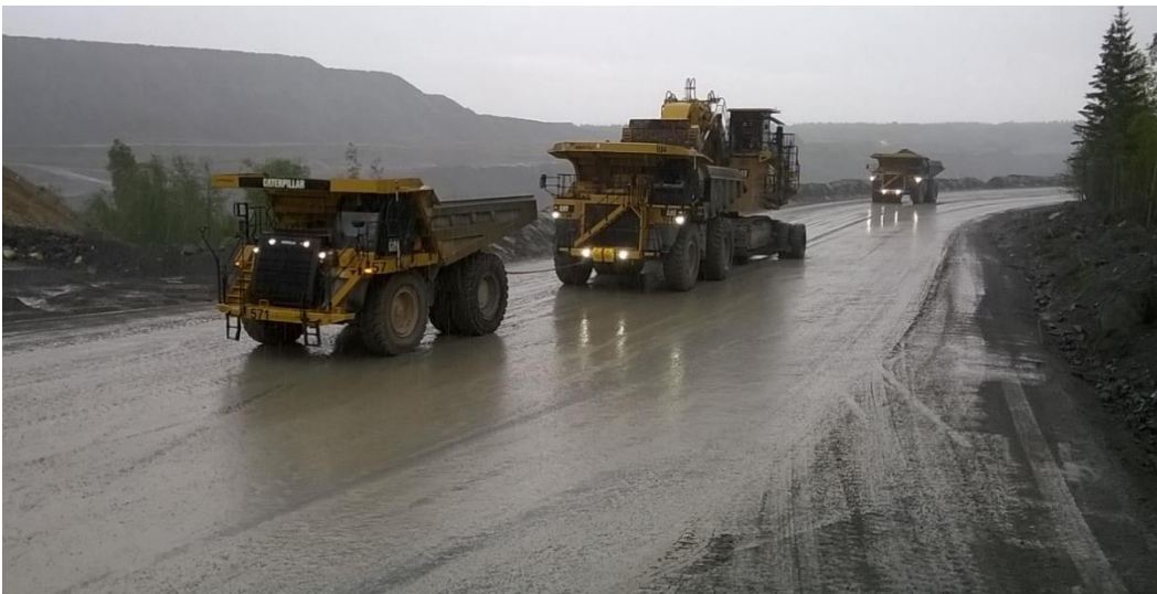
Kuva 3. Konesiirto kahdella louheautolla.
