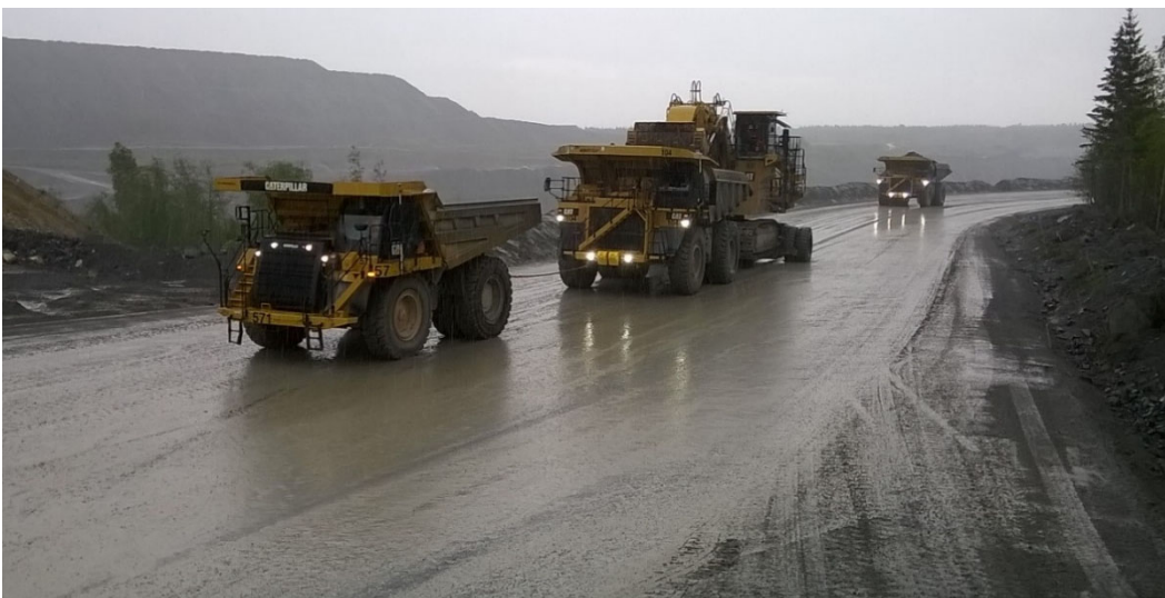
Kuva 3. Konesiirto kahdella louheautolla.
